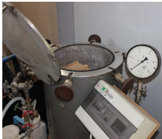
Attēls 14. Impregnēšanas iekārta.
