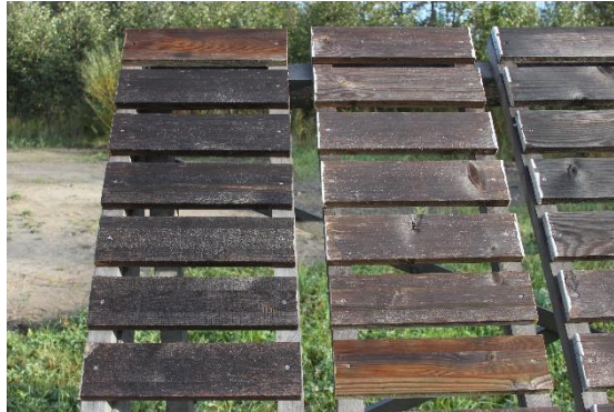
Attēls 15. Paraugi ar antipirēniem apstrādātai koksnei dabiskās novecināšanas stendā, (ekspozīcija 45°)
